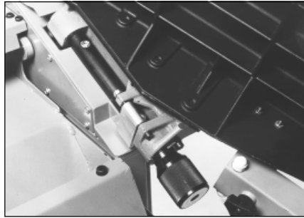
Nach dem Hochklappen der Abrichtplatten die Sicherungshebel auf Funktion prüfen.
